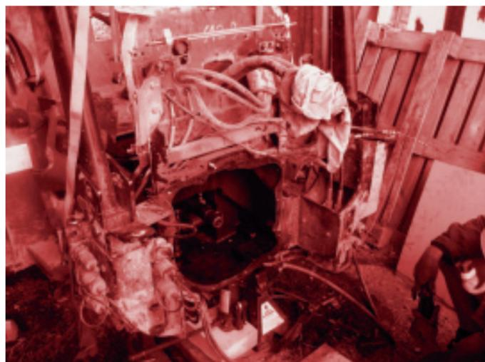
Sur conseil d'un ami mécanicien agricole, nous tronçons le cache, dépourvu de quelques boulons, et séparons le tracteur en deux pour accéder à l'endroit suspecté d'être responsable de la panne. Couper le tracteur en deux signifie déboulonner la couronne de boulons qui tient le tracteur en une seule pièce fonctionnelle.
